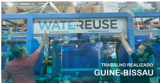
A empresa Watereuse contribuiu para o projeto landa Guiné, na Guiné-Bissau, através do fornecimento de um sistema contentorizado de filtração, desferrização e desinfecção de água. Este foi considerando um passo importante para a melhoria dos níveis do abastecimento e distribuição de água na localidade de Mansôa.
